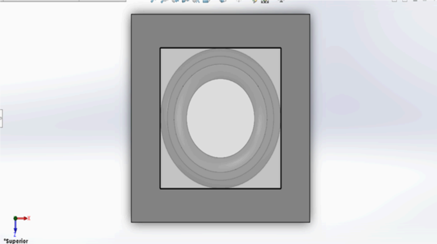
Figura 6 Vista superior del colector térmicos solar hecho con neumáticos desechados. (Autor, 2017)
