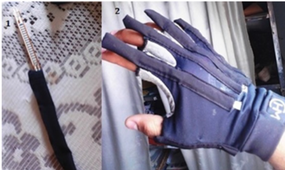
Figura 6. Funda para los sensores de flexión y acople al guante. Fuente: elaboración propia
